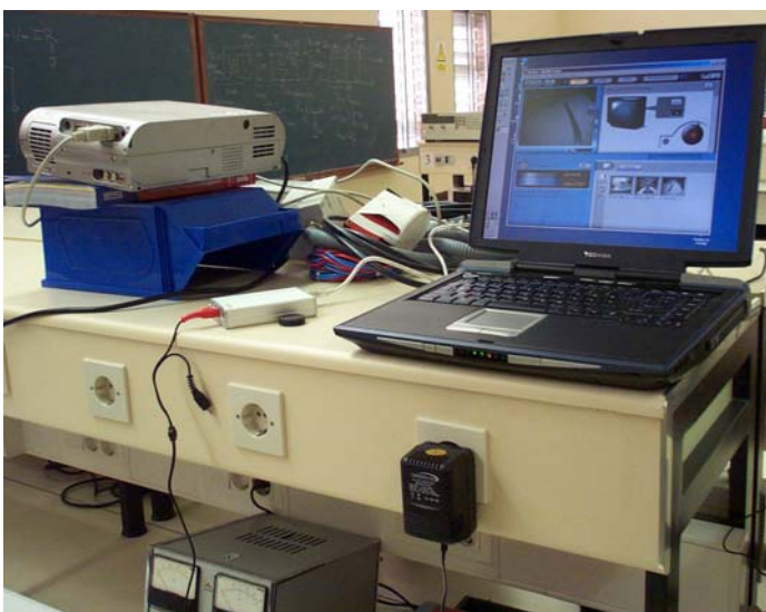
Figura 3: Detalle del cañón de proyección de la tarjeta de adquisición de vídeo y del ordenador donde se graba.
