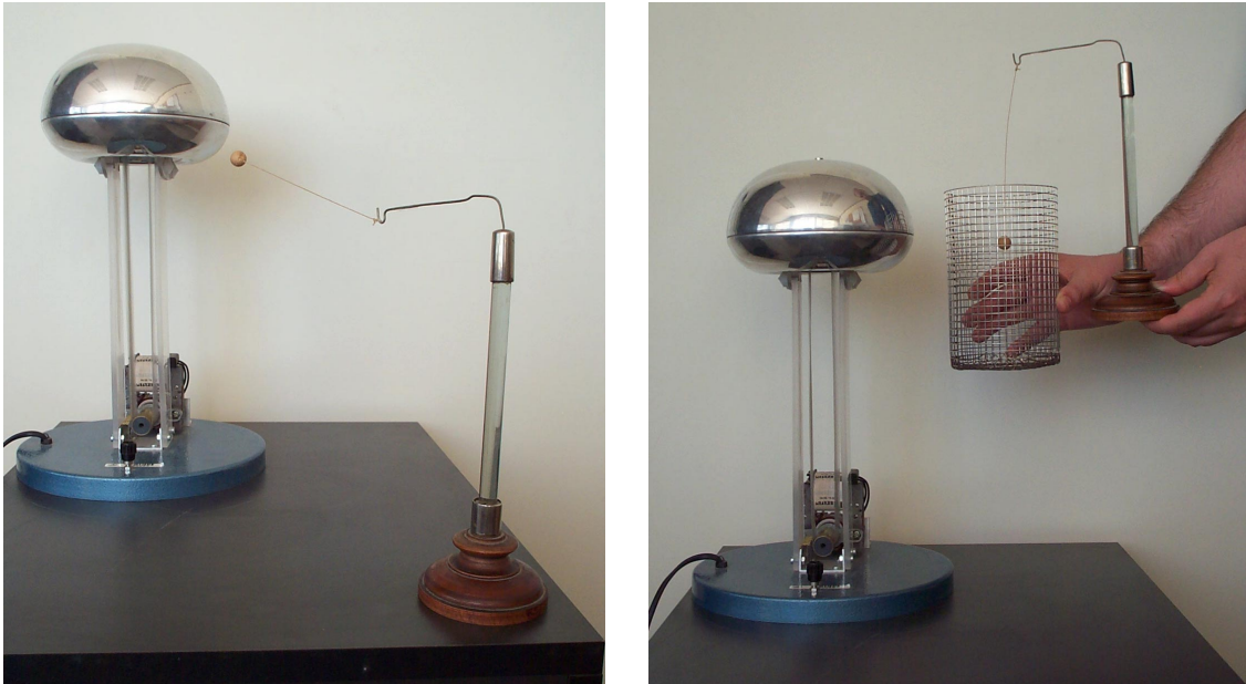
Figura 2. Generador de Van de Graaff y jaula de Faraday.
