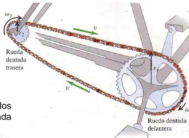
La rapidez angular de cada rueda dentada es inversamente proporcional al número de dientes. En una bicicleta de varias velocidades obtendremos la máxima velocidad angular  $\omega_2$  de la rueda trasera para un pedaleo dado  $\omega_1$  cuando el cociente  $\frac{N_1}{N_2}$  es máximo.
