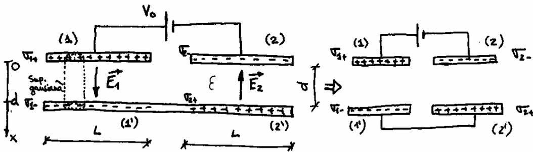
La zona de la placa inferior que está debajo de la placa (1) la he denominado (1'). En (1') aparece una densidad de carga  $\sigma_{1-}$  igual y de signo contrario a la de (1),  $\sigma_{1+}$  (esto se puede comprobar tomando una superficie gaussiana tipo "lata" con la tapa superior e inferior en (1) y (1') y viendo que  $\Phi_0 = 0 = q_{\text{enc}}/e$
