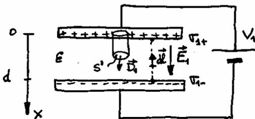
Dada la simetría, aplicando la ley de Gauss para  $\vec{D}$  a la superficie dibujada tenemos:
