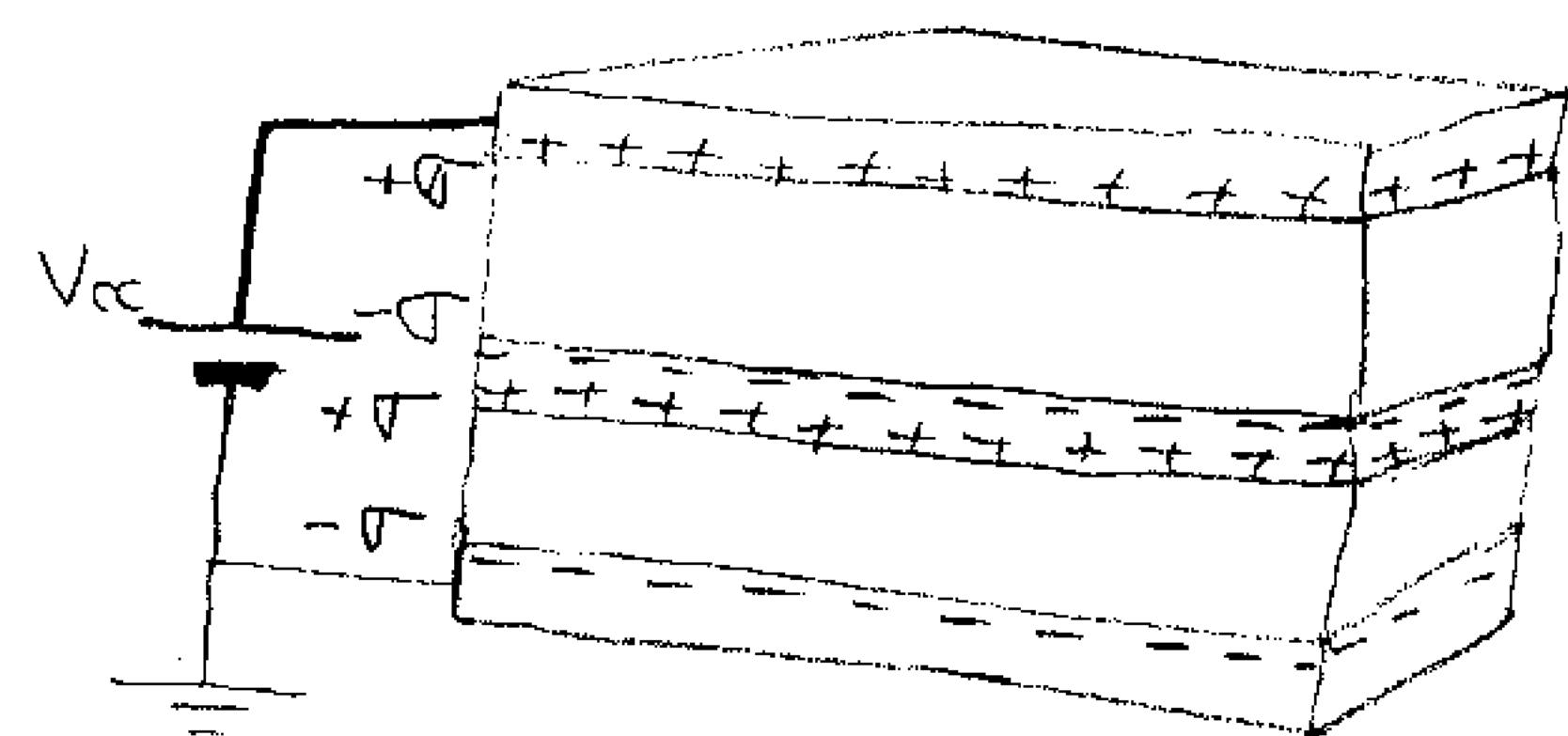
c) En este apartado no cambia el potencial de la lámina intermedia. Al unir la placa superior y la lámina intermedia, simplemente se neutralizan las cargas en contacto con la fibra de vidrio
