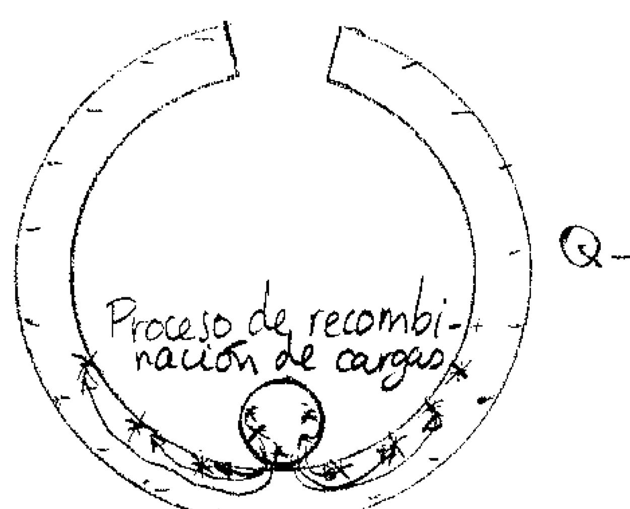
Se produce un chispo y unas corrientes transitorias en el proceso de cancelación de la carga de la bola con la carga inducida.
