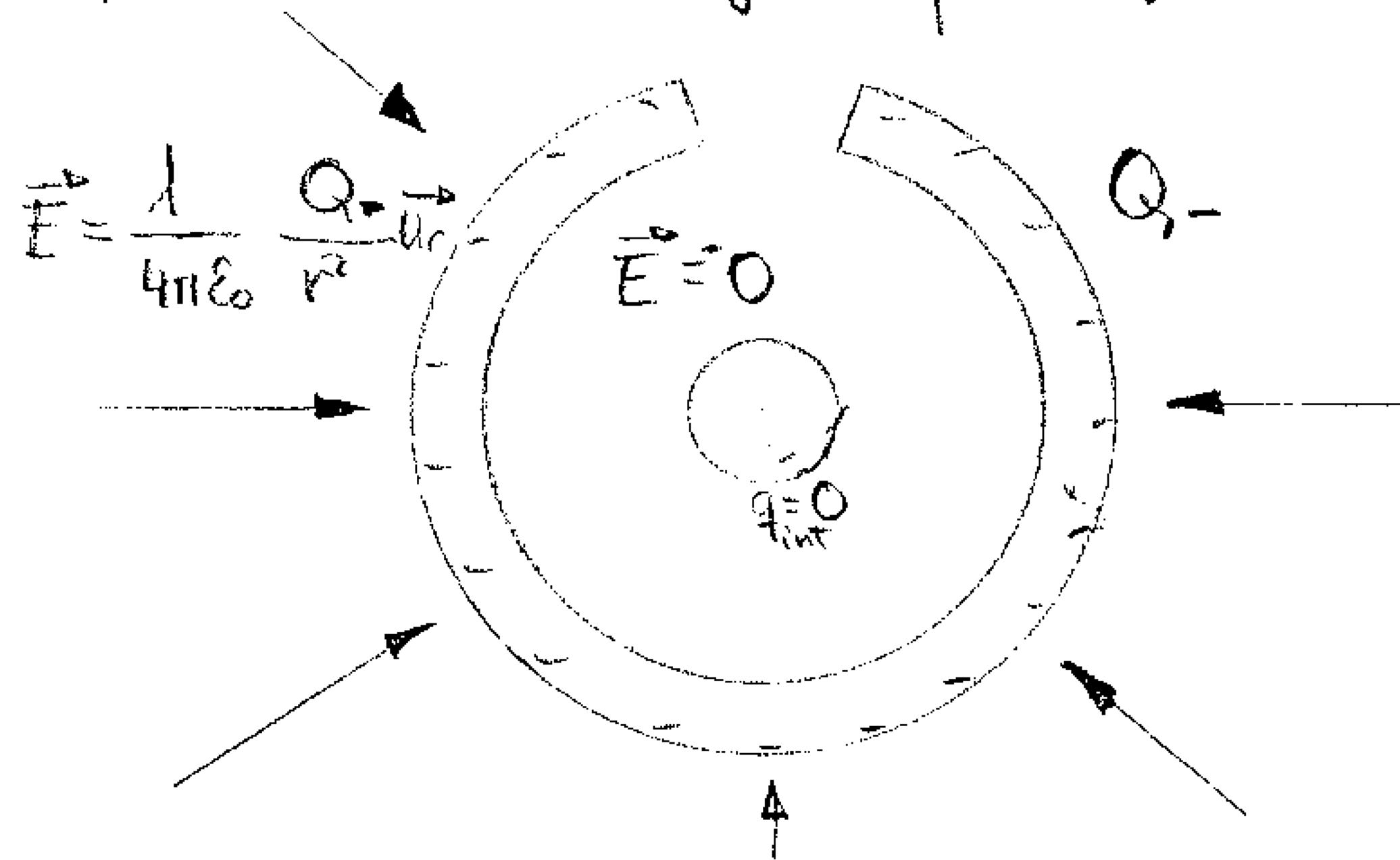
Al ponerse en contacto la bola con el cascarón, se disipa energía en las corrientes transitorias (la carga de la bola se recombina totalmente con la carga inducida en el interior del cascarón). Al final, dentro del cascarón se anula el campo eléctricamente y el sistema ha evolucionado al estado de menor energía compatible con el hecho de que el sistema bola-cascarón está aislado.
