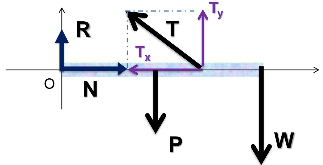
Las fuerzas sobre la viga se indican en la figura. La fuerza ejercida por el gozne se representa mediante sus componentes,  $N$  y  $R$ .
