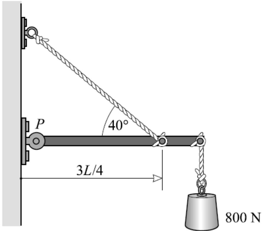
Examine el diagrama que se muestra en la figura. La viga uniforme de 600 N está sujeta a un gozne en el punto  $P$ . Calcule la tensión en la cuerda y las componentes de la fuerza de reacción que ejerce el gozne sobre la viga.
