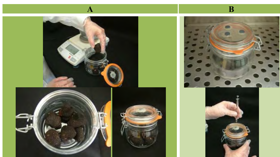
Figura 4.4.1. Preparación de los frascos con trufas para la determinación de la actividad respiratoria (A) y detalle del septum y toma de muestra gaseosa (B).
