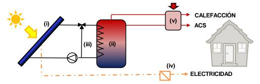
Esquema de los principales componentes del sistema S-CHP: i) colectores PVT, ii un tanque estratificado de almacenamiento de agua, iii) un circuito cerrado tanque-PVT, iv) baterías eléctricas and v) caldera auxiliar.
