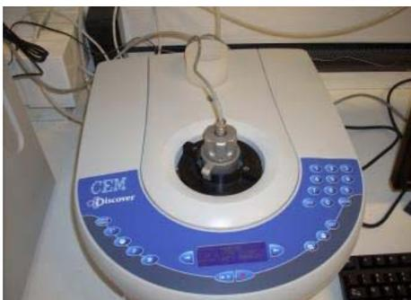
Reactor de microondas radial Discover de CEM, que permite calentar hasta 300°C usando potencias de hasta 300W. Este equipo permite trabajar en condiciones de temperatura o potencia constantes. Es posible trabajar con muestras de escala analítica (5mL) a preparativa (hasta 100mL).
