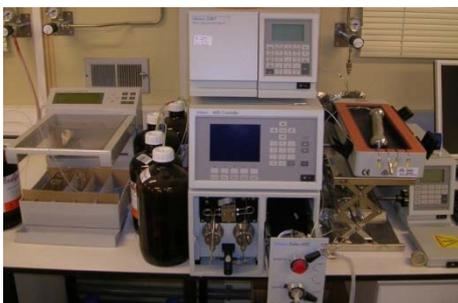
Sistema de cromatografía líquida de escala semipreparativa modelo Waters Delta 600 para aplicaciones tanto analíticas como semipreparativas equipado con detector de UV/VIS dual Waters 2487 colector de fracciones. Se dispone de columnas tanto quirales (chiralpack IA/IB de Daicel) como de fase reversa (Luna C18 25cmx25mm de Phenomenex).
