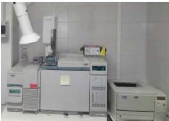
Sistema de cromatografía de gases con detector selectivo de masas compuesto por un cromatógrafo con inyector automático Split/splitless Agilent 6890N/G1530N y detector selectivo de masas Agilent 5973N.
