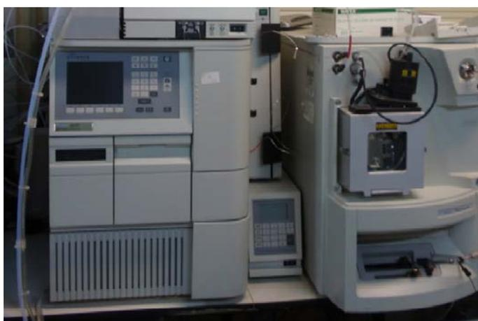
Sistema de cromatografía líquida compuesto por inyector automático Waters Alliance 2695 equipado con detector de UV/Vis con fotodiodos (PDA) Waters 2696 y detector de masas Waters ZQ4000. El detector de masas está equipado con sondas de ionización ESI y APCI y detector de cuadrupolo sensible hasta 4000 uma que puede operar tanto en modo SIM (single Ion
