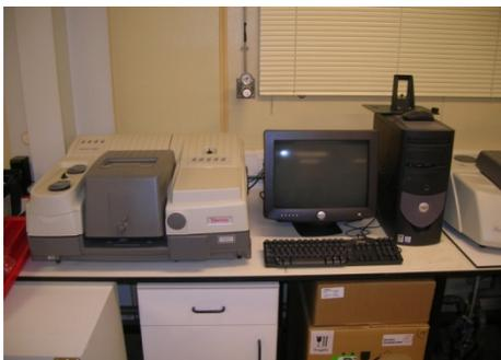
Espectrofotómetro de infrarrojo: Nicolet Nexus 5700 que trabaja en el rango de frecuencias  $4000-400\text{cm}^{-1}$ . Se dispone de accesorios de reflectancia difusa para muestras en fase sólida (smart collector de Thermo), y de ATR para muestras en fase líquida (Smart durasampl IR de Thermo). Además se dispone de cámara catalítica para experimentos a alta presión/vacío y
