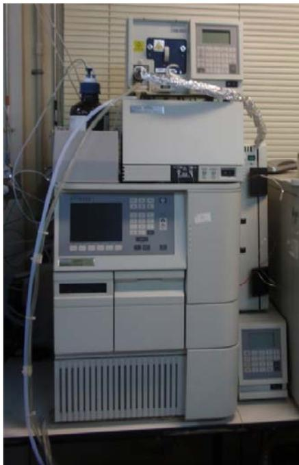
Sistema de cromatografía líquida compuesto por inyector automático Waters Alliance 2695, detector de UV/Vis con fotodiodos (PDA) Waters 2696 y detector de light scattering evaporativo (ELSD) Waters 2420. Este equipo permite realizar análisis cromatográfico tanto en fase normal como en fase reversa de analitos tanto con cromóforos que absorben en el rango UV-Visible como sin ellos.
