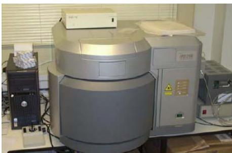
Espectrómetro Raman Dispersivo equipado con dos fuentes de luz: Diodo Verde 532 nm (30 mW) y Diodo Rojo 785 nm (500 mW)) y detector tipo CCD de hasta 1800 líneas.
