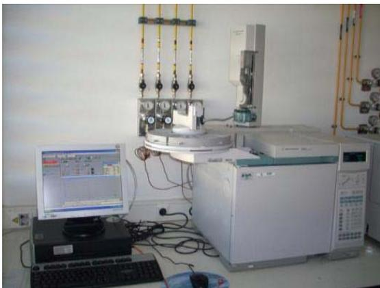
Sistema de cromatografía de gases con detector FID Agilent 6890N equipado con inyector automático Split/splitless Agilent G1530N.
