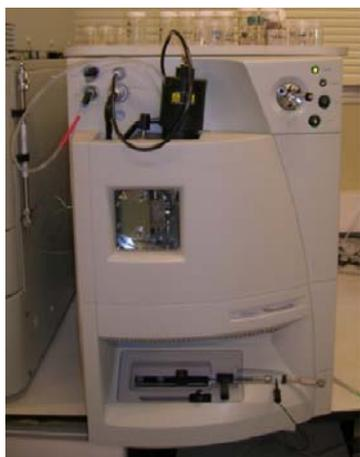
Detector de masas Waters ZQ4000. Este equipo está equipado con sondas de ionización ESI y APCI y detector de cuadrupolo sensible hasta 4000 uma. Este equipo permite realizar análisis de espectroscopia de masas de productos que puedan ionizar en las sondas disponibles, para lo que es necesario que contengan grupos polares que favorezcan la ionización.
