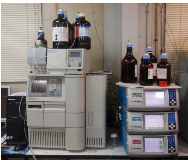
Sistema de cromatografía líquida para aplicaciones de cromatografía de exclusión por tamaño (SEC): permeación en gel (GPC) o de filtración en gel (GFC). El sistema está compuesto de inyector automático modelo Waters Alliance 2695 y un tándem de detectores de UV/VIS dual Waters 2487, de Light scattering multi ángulo (MALS) MiniDawn (3 ángulos) de Wyatt Tech. acoplado a un viscosímetro (DV) y a un detector de índice de refracción (RI).
